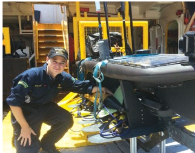
O veículo autônomo tipo Wave Glider foi utilizado em ações de monitoramento acústico passivo em regiões oceânicas
